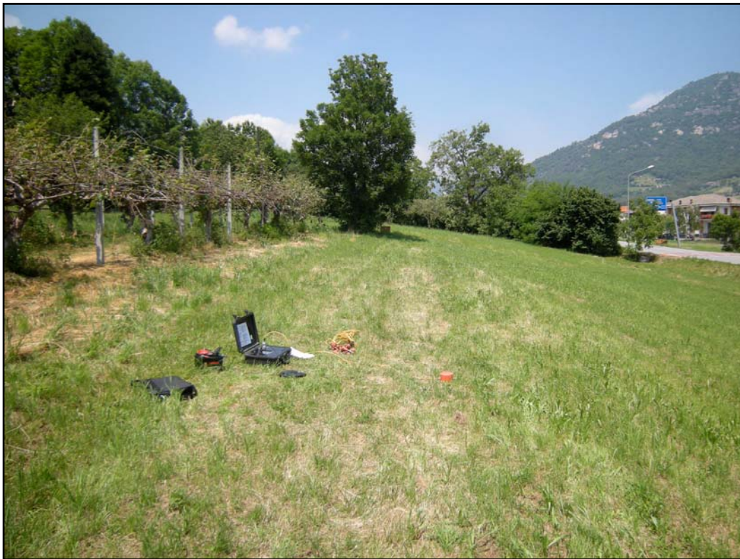
Sismografo EEG con geofono triassiale in fase di acquisizione
